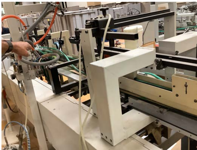
Anschließend können noch kleine Fenster von einer weiteren Maschine eingeklebt werden. Dann verklebt eine andere die geschnittenen Kartons.
