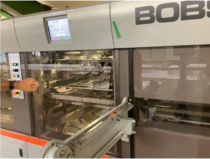
Die bedruckten Farbkartons werden von einer Maschine zerschnitten.
